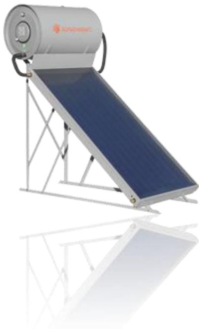
Il sistema a circolazione naturale SONNENKRAFT, ampiamente rivisto e migliorato, funziona grazie alla forza di gravità (circolazione naturale senza necessità di pompe). Questo economico sistema consiste in un collettore, un serbatoio con doppia smaltatura, anodo al magnesio e sistema di fi ssaggio e viene assemblato in opera. E' una ulteriore ideale per le piccole utenze in climi miti.
