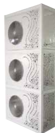
Moto-evaporanti D esterne (3 Booster) tricompressore a 3 circuiti indipendenti con 3 gradini di parzializzazione (100%-66%-33%-0%) kW 23,4 totali
